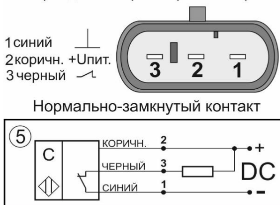
Схема соединения (Вид со стороны разъема)
