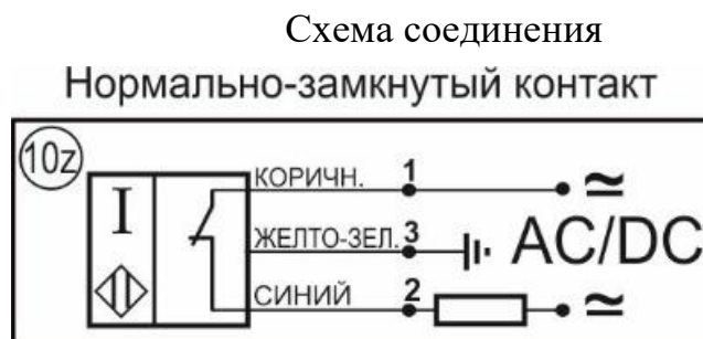
Цоколевка клеммной колодки
