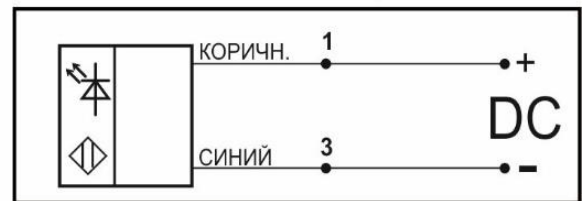
Схема соединения оптического излучателя
